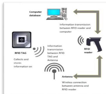
Gambar 1. Komponen RFID
