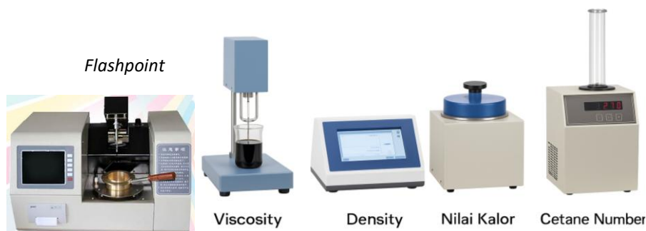
Gambar 4. Parameter pengujian fisikokimia biodiesel B35.
