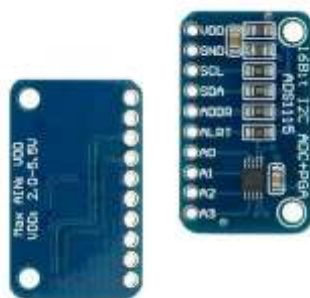
Gambar 6. Konverter dan Penguat Sinyal ADS1115.
