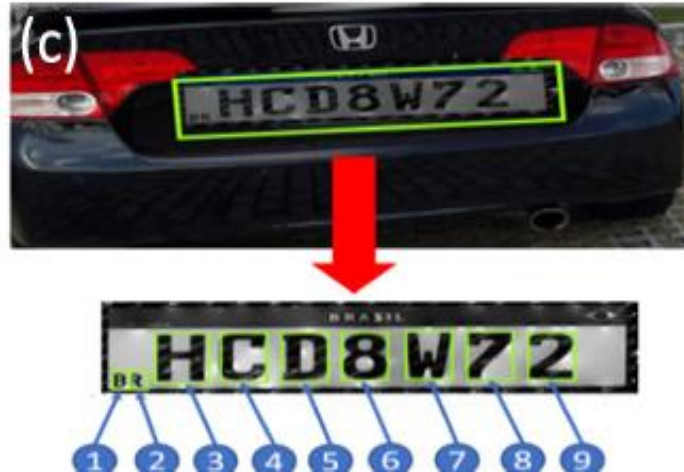
Gambar 9. Contoh Aplikasi Kamera untuk Identifikasi Pelat Kendaraan. Sumber: Tang et al. (2022)
