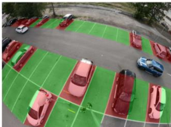
Gambar 8. Contoh Aplikasi Kamera untuk Monitoring Slot Parkir Kosong. Sumber: Hudda et al. (2024)
