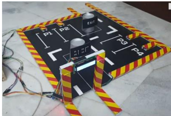
Gambar 5. Prototipe Sistem Parkir Cerdas Menggunakan Sensor Inframerah.
