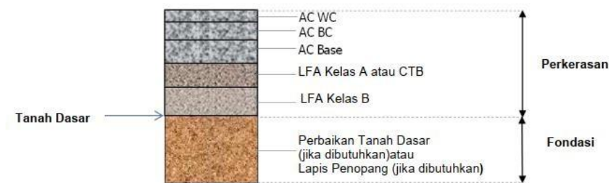
Gambar 2. Struktur Perkerasan Lentur dibangun di atas Permukaan Tanah Asli (At Grade)
