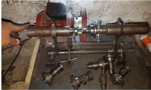
**Gambar 2.** Proses pemaprasan camshaft
