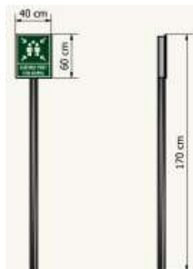
Gambar 7. Desain tiang papan penunjuk titik kumpul
