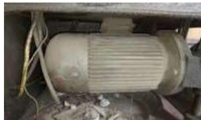
Gambar 1. Motor induksi 3 fasa
