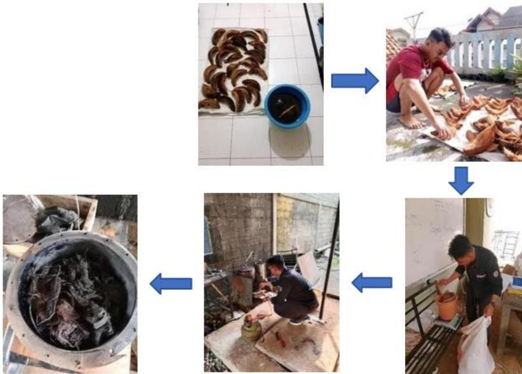
**Gambar 2.** Proses pembuatan bioarang
