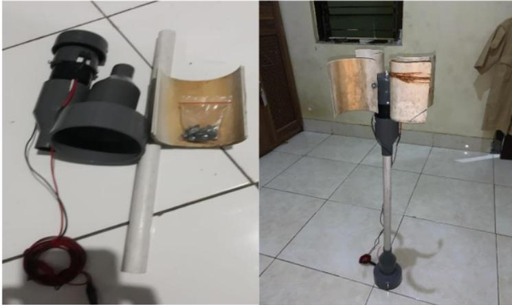
Gambar Proses Perancangan dan Pembuatan *Wind Turbine*
