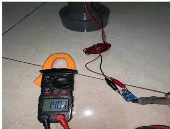
Gambar Pengujian Boost Converter
