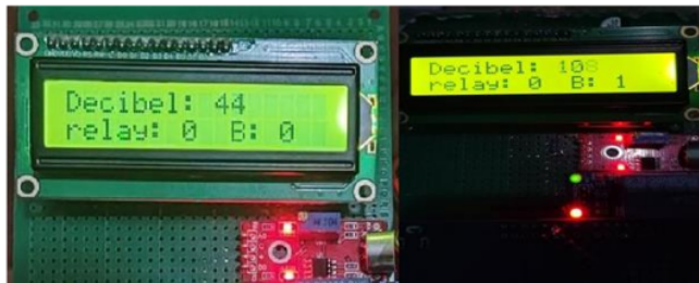
Gambar 4. 2 Pengujian Sensor Suara Ky-037 (a) Tanpa Suara Bising. (b) Dengan Memberikan Suara Gerinda.
