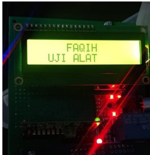
Gambar 4. 3 Pengujian LCD 16x2.
