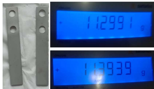
Gambar 5. Deteksi Korosi Timbangan Berat Lokasi Tambak Rejo Tambak Lorok
