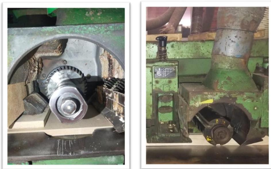
Gambar 8. Mata Pisau Pada Mesin *Moulding Unimat 22 A*
