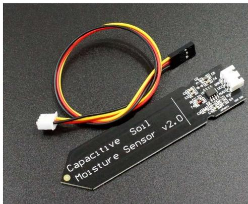
Capacitive Soil Moisture Sensor Merupakan sensor yang bisa mengukur kelembaban tanah. Sensor ini bekerja berdasarkan prinsip kapasitansi, yang berarti sirkuit tercetak bebas karat karena dilapisi dengan lapisan pernis sirkuit tercetak. Keluaran dari sensor ini berupa tegangan analog 1,2 hingga 2,5 V.
