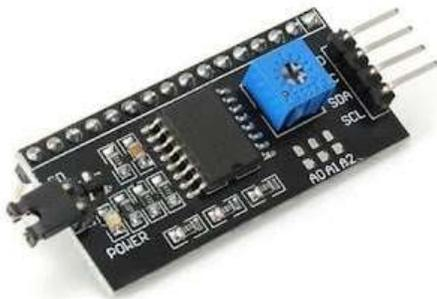
Inter Integrated Circuit atau biasa dikenal dengan I2C adalah standar komunikasi serial dua arah yang menggunakan dua saluran yang dirancang khusus untuk mengirim dan menerima data. Sistem I2C terdiri dari saluran SCL (Serial Clock) dan SDA (Serial Data) yang membawa informasi data antara I2C dan controller.
