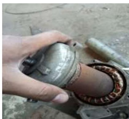
**Gambar 6. Pemisahan Rotor dan Stator**
