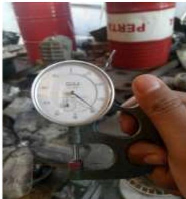
**Gambar 9. Menentukan Diameter Kawat Dengan *Teclock***
