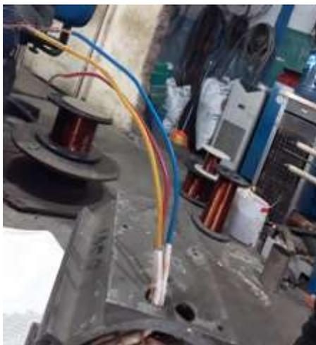
**Gambar 17. Penentuan kabel Output**
