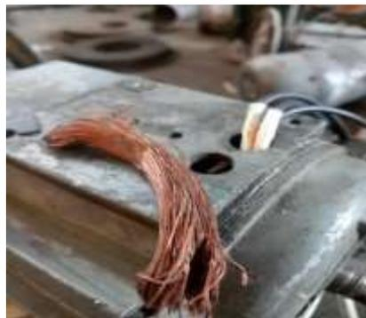
**Gambar 8. Gulungan Kawat di Alur Stator**
