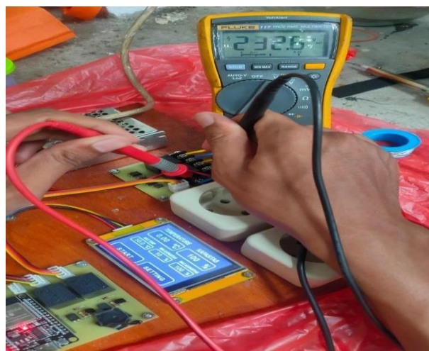
Gambar 5. Pengujian Heater terhubung dengan tegangan 220V
