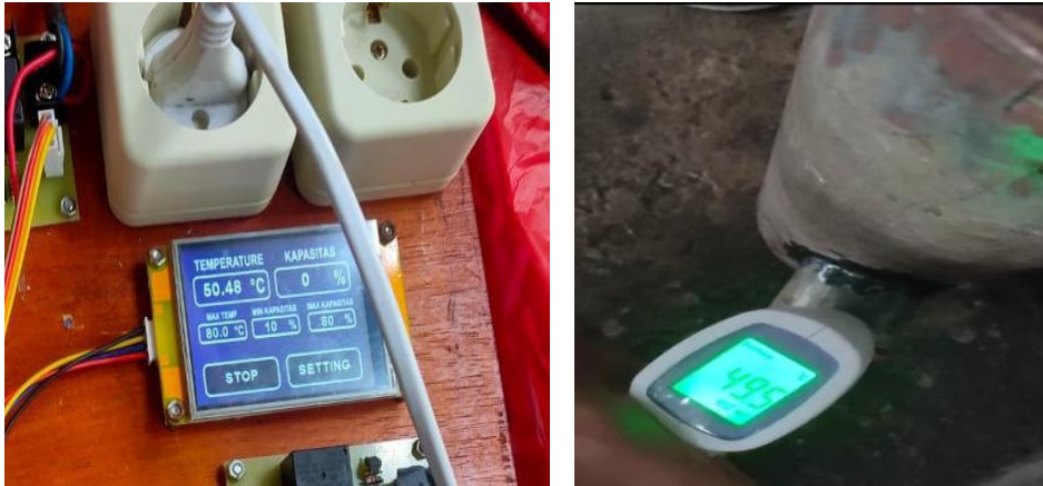
Gambar 6. Pengujian Sensor DS18B20
