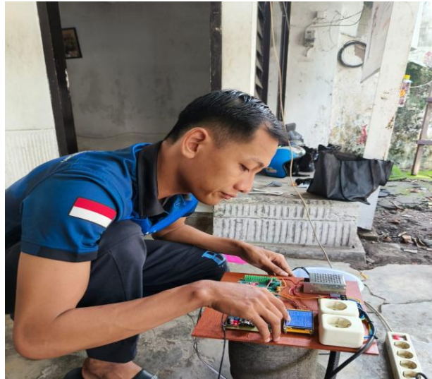
Gambar 2. Penujian sensitivitas HMI
