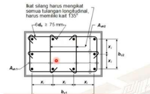
Gambar 9. Contoh penulangan transversal pada kolom dengan P_u > 0,3A_g f_c' atau f_c' > 70 \text{ mpa}
