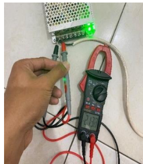
Gambar 11. Input Tegangan 220V.
