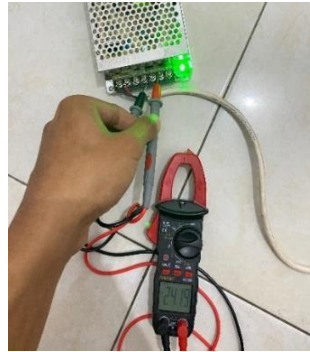
Gambar 12. Output Tegangan 24V.
