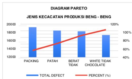
Dari diagram pareto di atas, terdapat 4 penyebab kecacatan yaitu patah, packing tidak sempurna berat tidak sesuai, dan whitechocolate tercemar. Penyebab paling utama kecacatan yaitu packing tidak sempurna dengan persentase dari total kecacatan adalah 29%. Penyebab lainnya yaitu patah dan berat wafer tidak sesuai dengan persentase masing-masing 29% dan 25%.
