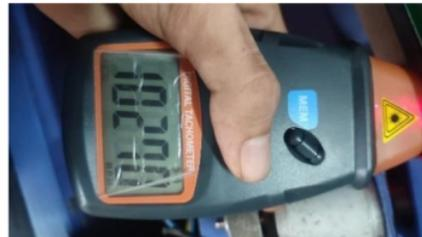
**Gambar 6.** Pengukuran Kecepatan Putar Pisau 1000 Rpm
