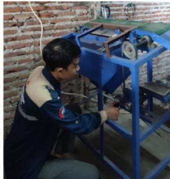
**Gambar 8.** Menekan Saklar Untuk Menggerakkan *Belt Conveyor*
