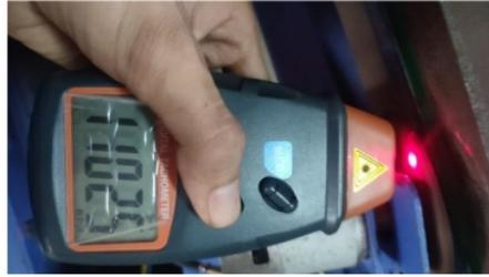
**Gambar 7.** Pengukuran Kecepatan Putar Pisau 1100 Rpm
