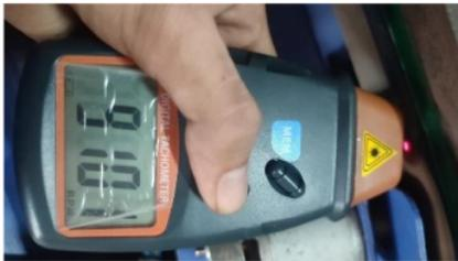
**Gambar 5.** Pengukuran Kecepatan Putar Pisau 900 Rpm
