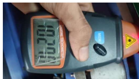
Gambar 6. Pengukuran Kecepatan Putar Pisau 1000 Rpm
