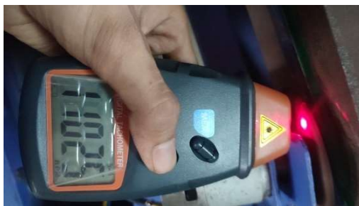
Gambar 7. Pengukuran Kecepatan Putar Pisau 1100 Rpm
