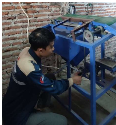
Gambar 8. Menekan Saklar Untuk Menggerakkan Belt Conveyor
