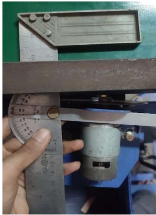
Gambar 2. Pengaturan Sudut Kemiringan Poros Pisau 8°
