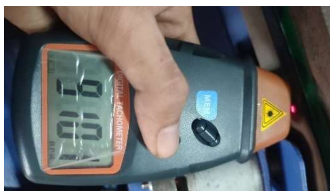
Gambar 5. Pengukuran Kecepatan Putar Pisau 900 Rpm
