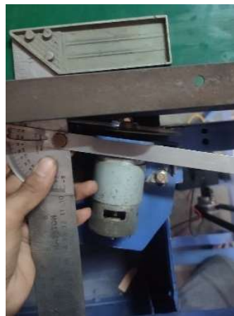
Gambar 4. Pengaturan Sudut kemiringan Poros Pisau 14°
