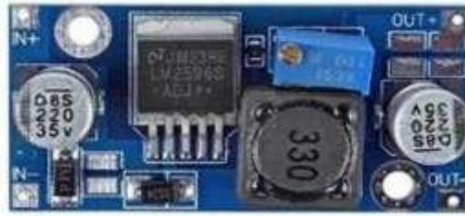
Gambar 4. Modul Konverter DC Penurun Tegangan
