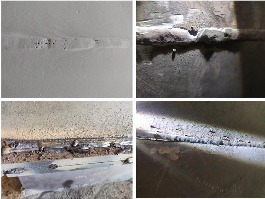
**Gambar 1. Jenis-jenis cacat pengelasan pada *project metal ducting* PT. Maxitherm Boiler Indonesia**
