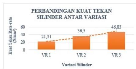
Gambar 2. Perbandingan Kuat Tekan Silinder Beton Antar Variasi
