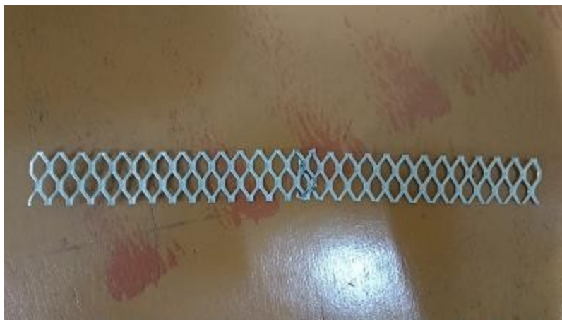
Gambar 7. Spesimen uji tarik ketebalan 0.4 mm
