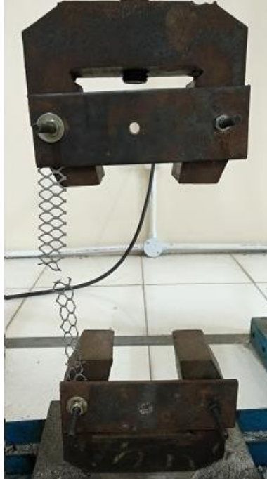
Gambar 3. Spesimen setelah uji tarik
