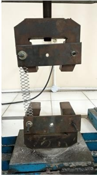
Gambar 2. Pemasangan spesimen pada mesin uji tarik
