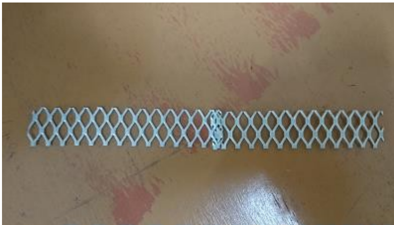
Gambar 10. Spesimen uji tarik sambungan lipat
