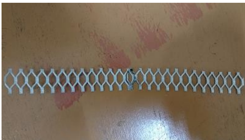
Gambar 8. Spesimen uji tarik ketebalan 0.5 mm
