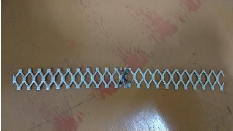
Gambar 9. Spesimen uji tarik ketebalan 0.6 mm
