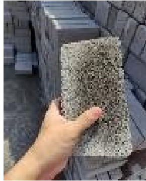
Gambar .5 Defect Paving Tidak Kering
