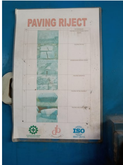
Gambar .1 Lembaran List Defect pada Produksi Paving Block
