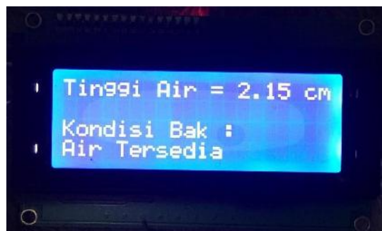
Gambar 10. Hasil pengujian dengan keadaan bak penampungan air terisi.
