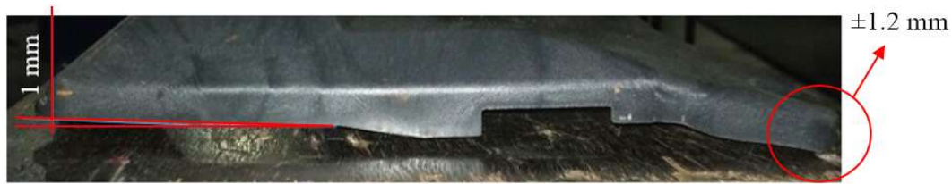
Gambar 5 Posisi cacat warpage pada tutup box antenna mobil
